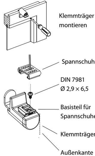
**NACHJUSTIEREN BEI SCHIEFSTAND OBERPROFIL**
