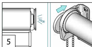
Rollo in Halterung einrasten lassen, End-
