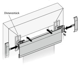
→ Der Befestigungsträger wird immer an die Innenkante des Fensterflügels montiert.
